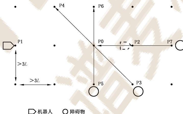
图 5 障碍物规避测试示意图
